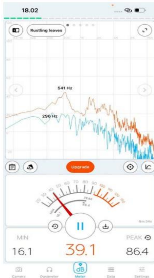
Gambar 5. Nilai kebisingan pada saat katup terbuka (muffler berukuran Panjang)
