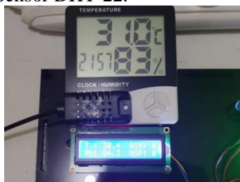
Gambar 4 Tampilan suhu dan kelembaban pada lcd I2C dan hygrometer
