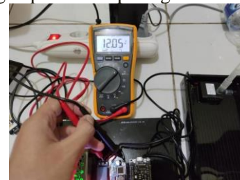
Gambar 5 proses pengujian pompa DC
