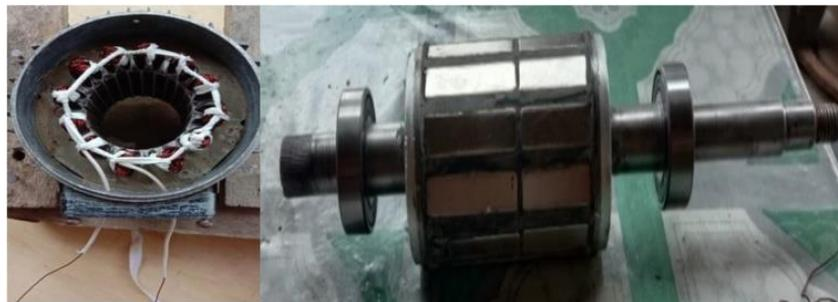
Gambar 3. Stator dan Rotor Generator
