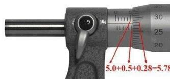
Gambar 4. Pembacaan Skala Mikromrter Sekrup
