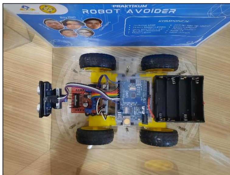
Gambar 4. Hasil rancangan robot avoider
